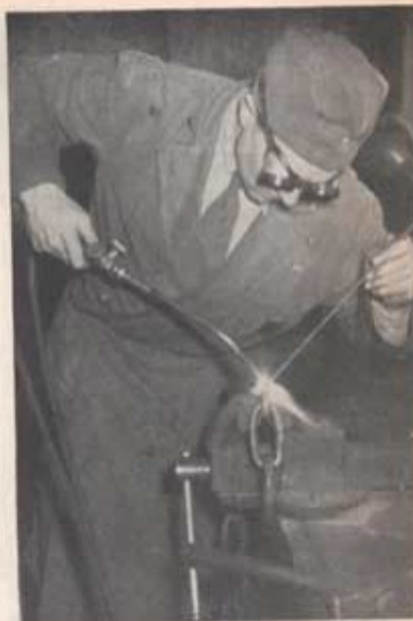
På utbildningsverkstaden är armétekniker Skog just i färd med att svetsa fast den färdige länken.
