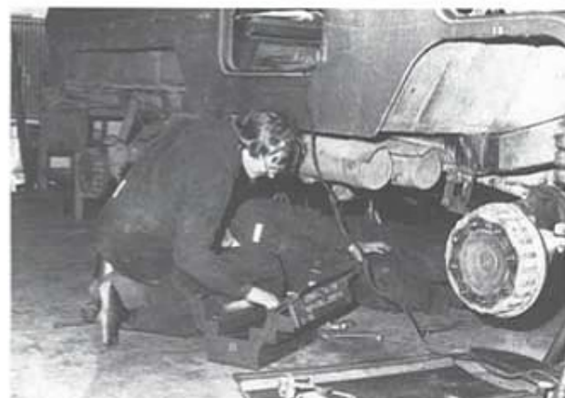
Pär-Anders Zeberg från Mörrum och Tomas Johansson från Helsingborg arbetar med bromssystemet på en terrängbil 11.
